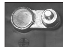
La BORNE POSITIVE (+) a un diamètre plus grand
