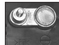
La BORNE NÉGATIVE (-) a un diamètre plus petit
