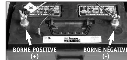
La BORNE POSITIVE (+) a un diamètre plus grand
