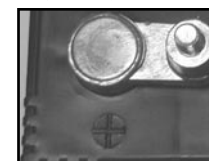
La BORNE POSITIVE (+) a un diamètre plus grand
