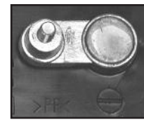
La BORNE NÉGATIVE (-) a un diamètre plus petit
